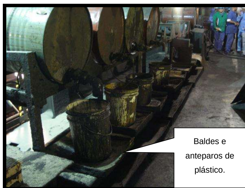
Figura 21 – Condição do local de armazenamento de resina. Fonte: Arquivo pessoal
