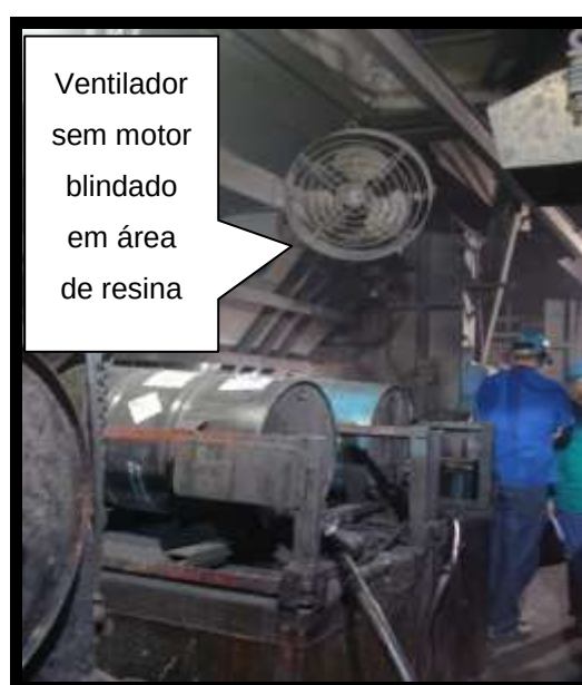
Figura 22 – Condição do local de armazenamento resina. Fonte: Arquivo pessoal
